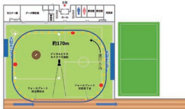
図1：スポーツパフォーマンス研究センターでの改良した測定方法の図
